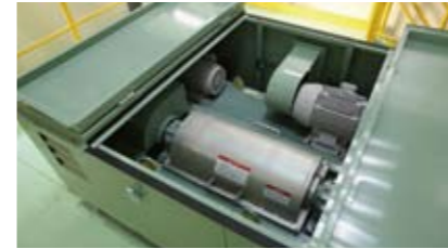
汚泥脱水機 凝集沈殿槽で発生した汚泥は、濃縮後、汚泥脱水機により固体と液体に分離します。
